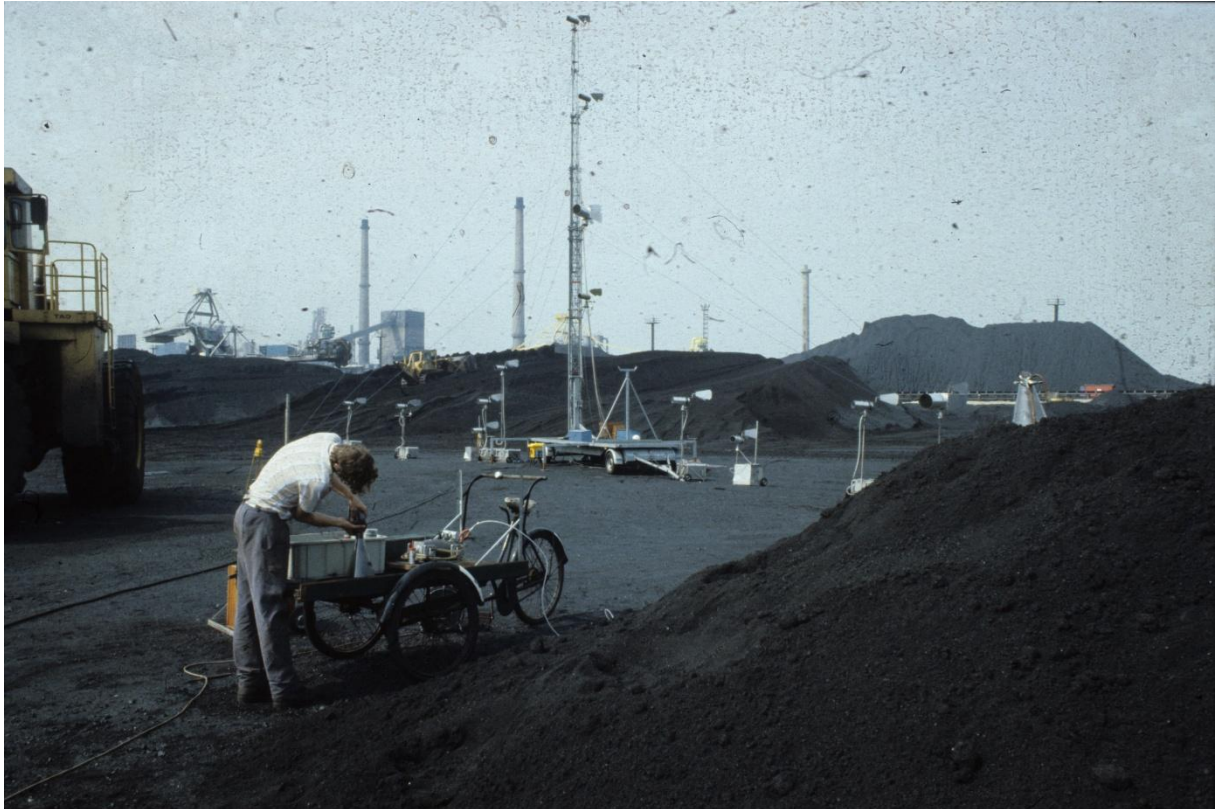
Figuur 3 Meetopstelling bij het storten van kolen
